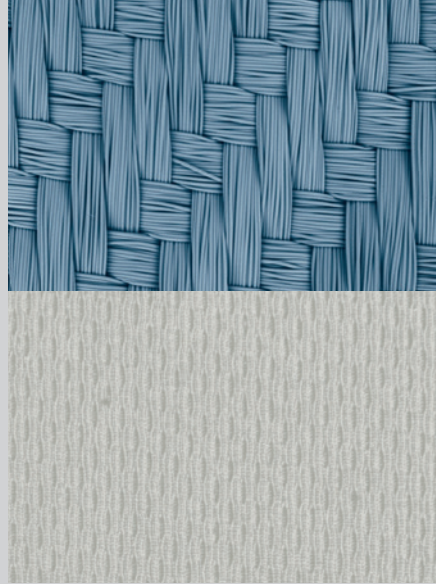
Abb. 2: Kombination 2 oben: Polyester/Carbon-Gewebe unten: reines Polyestergestrick
