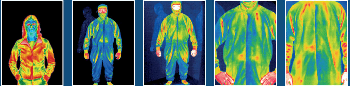
Ces prises de vue thermiques prouvent que sur un certain laps de temps la chaleur peut s'accumuler sous les vêtements pour salle propre.
