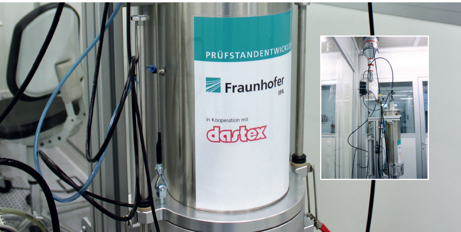
Nouveau banc d'essai de filtration pour tissus pour salles propres, une création en commun de Dastex et du Fraunhofer IPA (Stuttgart)
